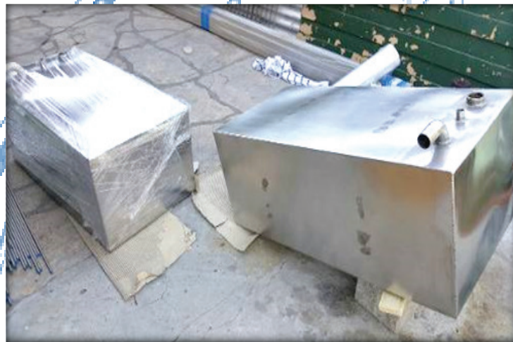
Cajón de lixiviados -Imecon Southern Perú
